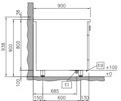
Electrical inlet (power) EQ Equipotential screw
